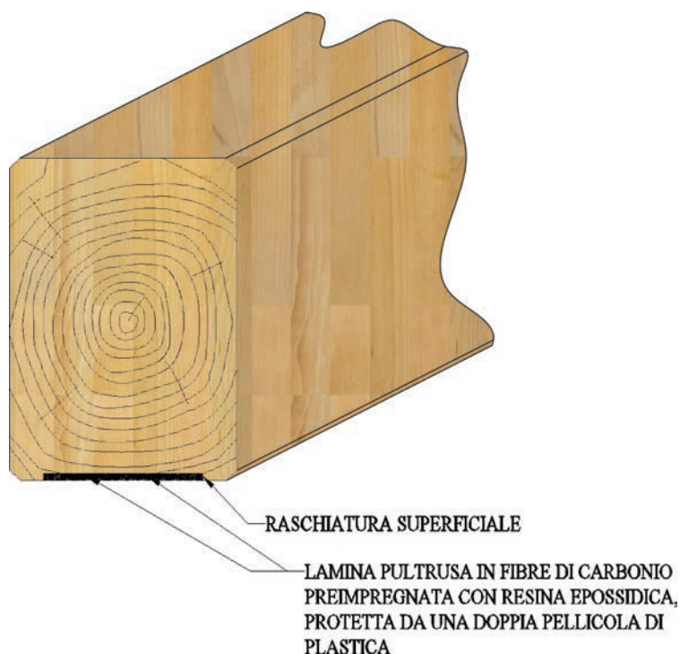
Figura 3.186. Rinforzo di elemento in legno con lamina pultrusa disposta all'intradosso.
