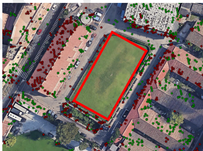
Figura 2.20 – Esempio di distribuzione spaziale dei punti di misura ottenuti dall'elaborazione interferometrica multi-temporale SBAS-DInSAR a piena risoluzione spaziale di due dataset ascendenti (punti di misura verdi) e discendenti (punti di misura rossi) in un'area del centro storico di Roma. Il rettangolo rosso identifica un'area dove non sono stati rilevati punti di misura.
