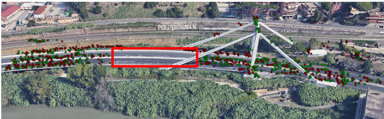
Figura 2.21 - Esempio di distribuzione spaziale dei punti di misura ottenuti dall'elaborazione interferometrica multi-temporale SBAS-DInSAR a piena risoluzione spaziale di due dataset ascendenti (punti di misura verdi) e discendenti (punti di misura rossi) in un'area a Sud-Ovest di Roma. Il rettangolo rosso identifica un'area dove non sono stati rilevati punti di misura.
