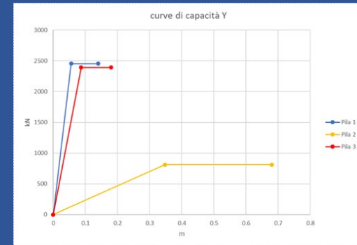
Curve di capacità delle pile nella direzione longitudinale e trasversale
