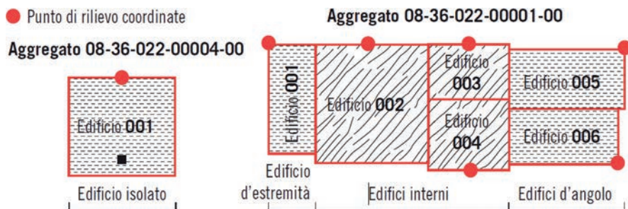
Figura 3.9. Posizione degli edifici nell'ambito delle UMI.
