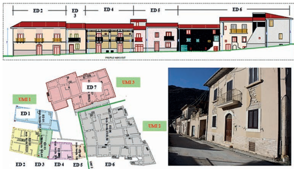
Figura 2.1. Esempio di un Aggregato edilizio (AE) del Comune di Villa Sant'Angelo (AQ), suddiviso in Unità Minime di Intervento (UMI), con evidenza degli edifici che lo compongono (ED).
