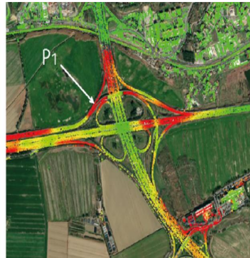
Mappa dello spostamento del ponte attraverso i dati SAR
