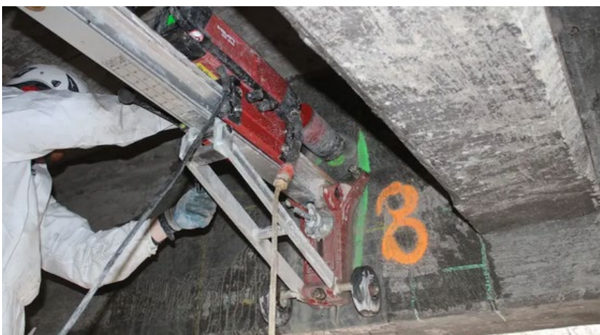
Carotaggi e prelievi di armature, prove indirette
