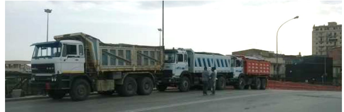
Carico eccentrico carreggiata 2 "E1-E4" carico
